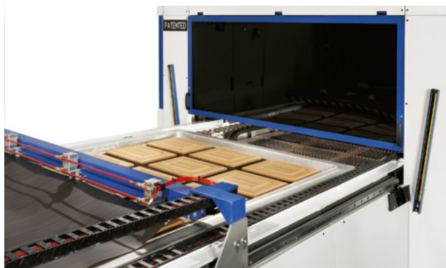
Figura 161 – Pin automatici per la lettura del pannello
