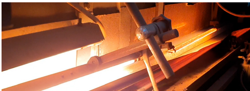
■ Figura 135 – Esempio di riscaldamento HPL in post-formatrice
