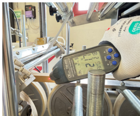
■ Figura 16 – Misurazione della temperatura dell'adesivo sul supporto
