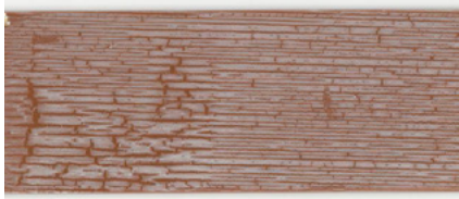
■ Figura 46 – Scarsa bagnabilità di un primer base acqua per trattamento corona insufficiente
