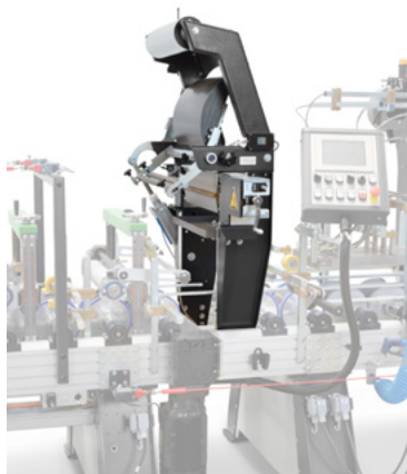
■ Figura 137 – Sistemi di pre-riscaldamento del decorativo
