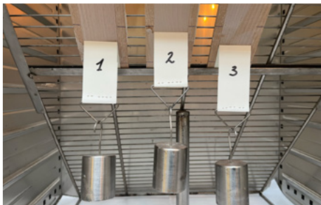
■ Figura 171 – Determinazione della resistenza al carico statico
