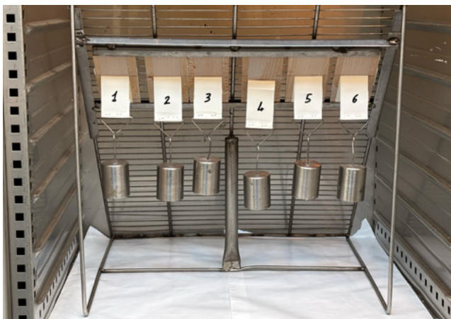
■ Figura 174 – Valutazione della resistenza a caldo di un adesivo
