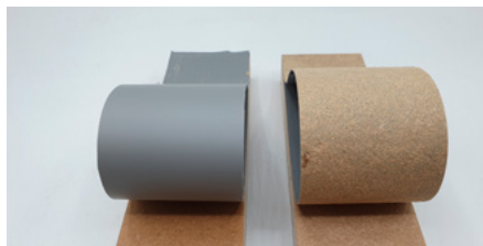
Figura 170 – Peeling manuale su pannelli con risultato negativo (a sinistra) e positivo (a destra)
