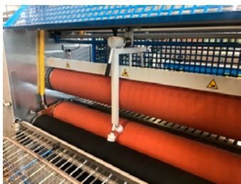
■ Figura 93 – Macchina a rulli per l'applicazione di adesivi termofusibili PUR direttamente su pannelli
