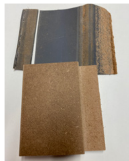
Figura 169 – Peeling manuale con risultato positivo solo sulle zone laterali del profilo dove si nota il cedimento coesivo del supporto (asportato)
