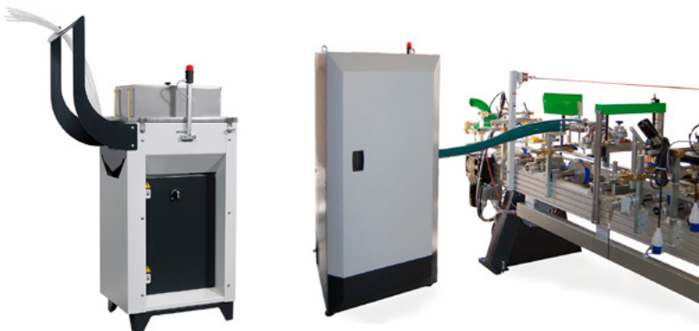
Figura 123 – Applicazione automatica del primer
