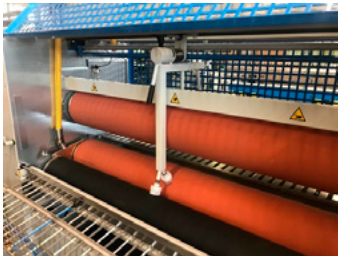
■ Figura 93 – Macchina a rulli per l'applicazione di adesivi termofusibili PUR direttamente su pannelli
