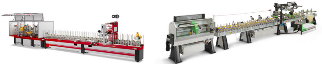
Figura 129 – Impianti per l'applicazione di adesivi termofusibili nel rivestimento profili
