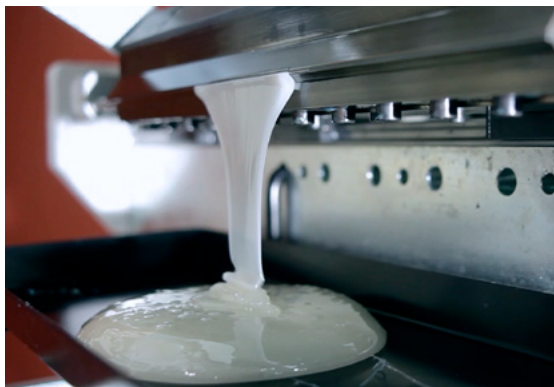
■ Figura 126 – Applicazione dell'adesivo con testa piana (Slot Nozzle)
