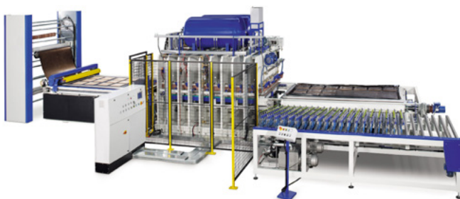
Figura 160 – Pressa a Membrana 3 vassoi e Pin automatici per la lettura del pannello
