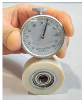
Ruota in gomma con durezza medio alta
