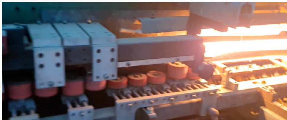
Figura 136 – Fase di piegatura del HPL con rulli di gomma
