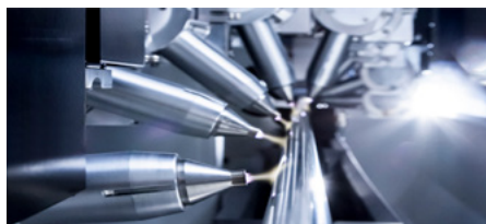
Figura 53 – Dettaglio delle torce al plasma motorizzate per il trattamento dei profili in alluminio. Per la preparazione dell'alluminio, la velocità della linea è generalmente inferiore rispetto ai processi che prevedono la preparazione di materiale polimerico.
