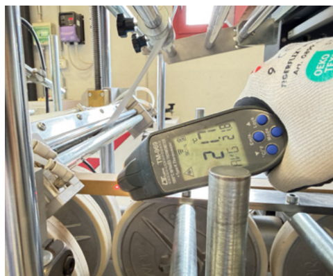
Figura 16 – Misurazione della temperatura dell'adesivo sul supporto
