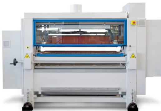
Figura 89 – Incollatrice con 4 rulli riscaldati
