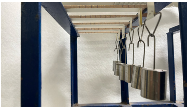
Figura 176 – Valutazione della resistenza a caldo di un adesivo
