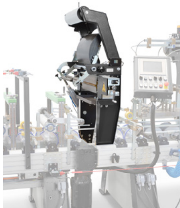
Figura 137 – Sistemi di pre-riscaldamento del decorativo
