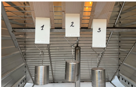
Figura 171 – Determinazione della resistenza al carico statico
