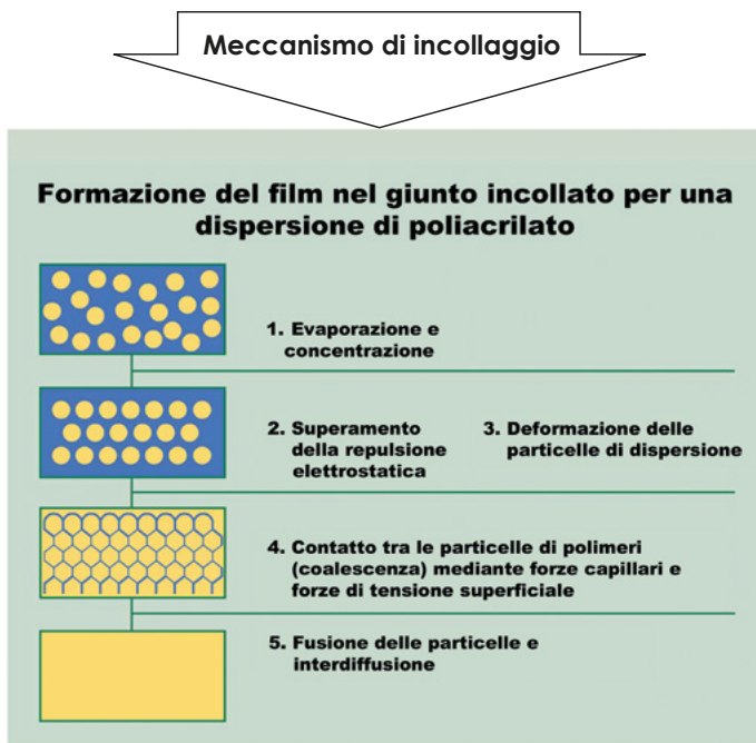
|| Figura 21 – Processo di filmazione di un adesivo in dispersione acquosa
