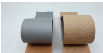
Figura 170 – Peeling manuale su pannelli con risultato negativo (a sinistra) e positivo (a destra)
