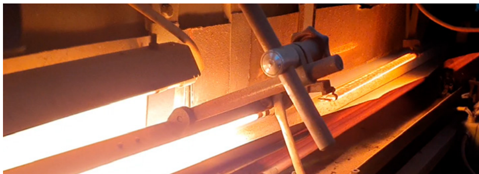
Figura 135 – Esempio di riscaldamento HPL in post-formatrice
