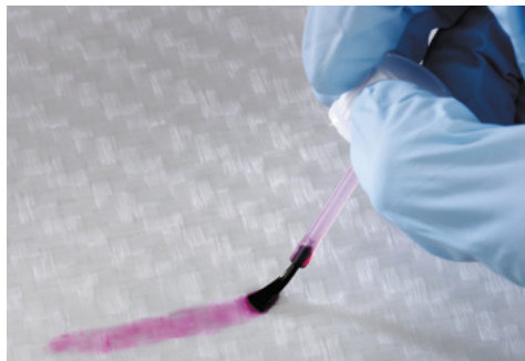
Figura 40 – Valore applicato 50 mN/m Liquido uniforme per almeno 3 sec. Bagnabilità \geq 50 mN/m
