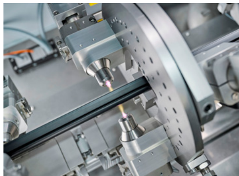
Figura 68 – Torce al plasma con ugello "puntuale" durante il trattamento di un profilo in polipropilene.
