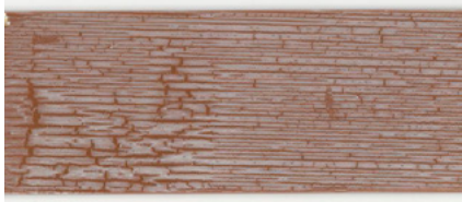
Figura 46 – Scarsa bagnabilità di un primer base acqua per trattamento corona insufficiente
