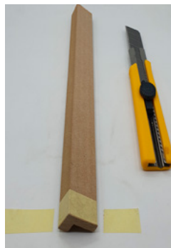
Taglio delle parti eccedenti del nastro di carta (evidenziando solo parte da rivestire)
