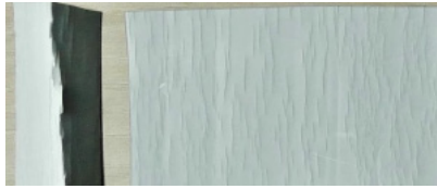
Figura 45 – Interazione solvente-PET (foglio lucido)
