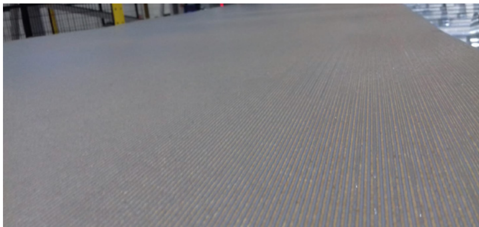
■ Figura 92 – Esempio di spalmatura ottenuta con rullo rigato a 14 filetti per pollice, accompagnato dal disegno del relativo profilo
